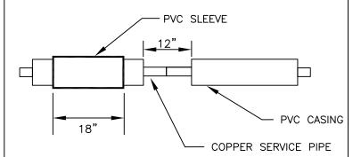
SLIDE SPLIT PVC SLEEVE OVER END OF PIPE CASING. TEST ALL SILVER BRAZED JOINTS AS REQUIRED.
