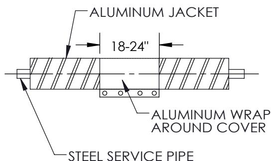
CENTER ALUMINUM WRAP AROUND COVER OVER FIELD JOINT AND TIGHTEN BOLTS.
